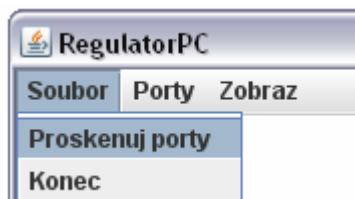
Obr. 3.7: Skenování dostupných COM portů
